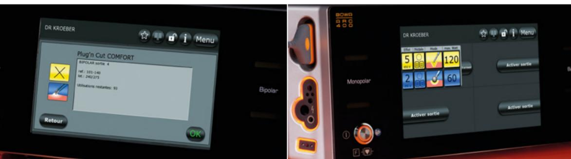
Plug'n Cut COMFORT : Le SYSTÈME COMFORT détecte automatiquement l'instrument COMFORT, indique le nombre d'utilisations pour lequel il est prévu, et présélectionne les paramètres appropriés au but d'utilisation.
