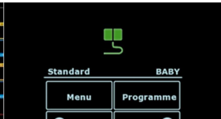
La surveillance de l'électrode neutre, ici dans le paramétrage pour bébés (max. 50 watts), vous informe sur le statut
