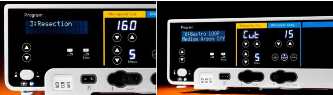
La gamme « résection » permet l'utilisation de 300 W pour la vaporisation avec des résectoscopes monopolaires.
