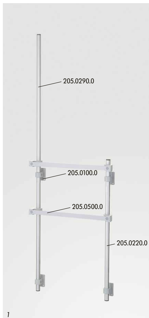
1 Châssis de fixation d'accessoires 205.4000.0 en aluminium/plastique, à fixer sur le côté du chariot fonctionnel, se compose de : 4 éléments de fixation de base (205.0100.0) 1 tube de base de 1500 mm (205.0290.0) 1 tube de base de 800 mm (205.0220.0) 2 rails porte-accessoires 25 x 10 x 510 mm (205.0500.0).
